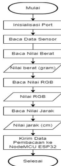
Gambar 4. *Flowchart* Kerja Sistem pada Arduino
