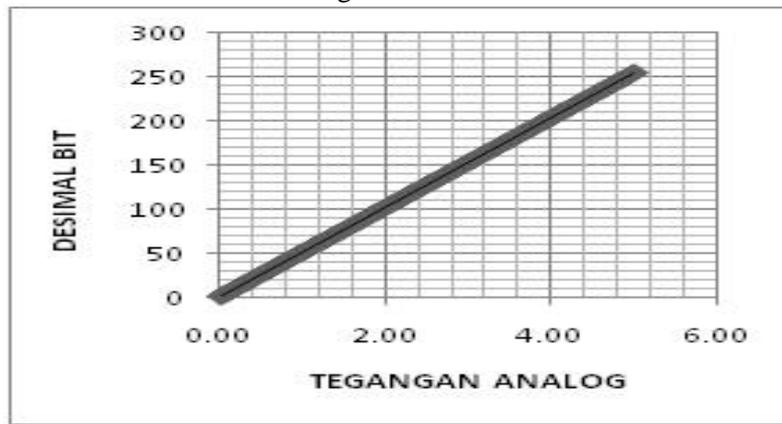
**Gambar 5** konversi tegangan analog ke data digital
