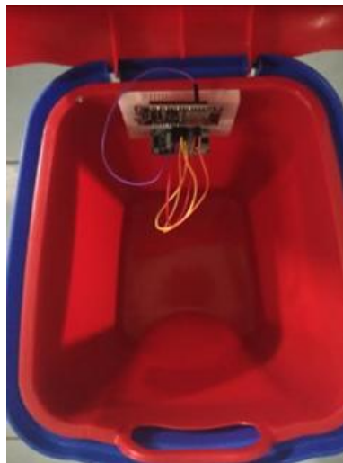
Gambar 10. Rangkaian Perangkat Keras ke media Tempat Sampah
