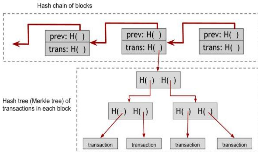
Gambar 1. Data transaksi yang dimasukkan dalam blockchain setelah di hash.
