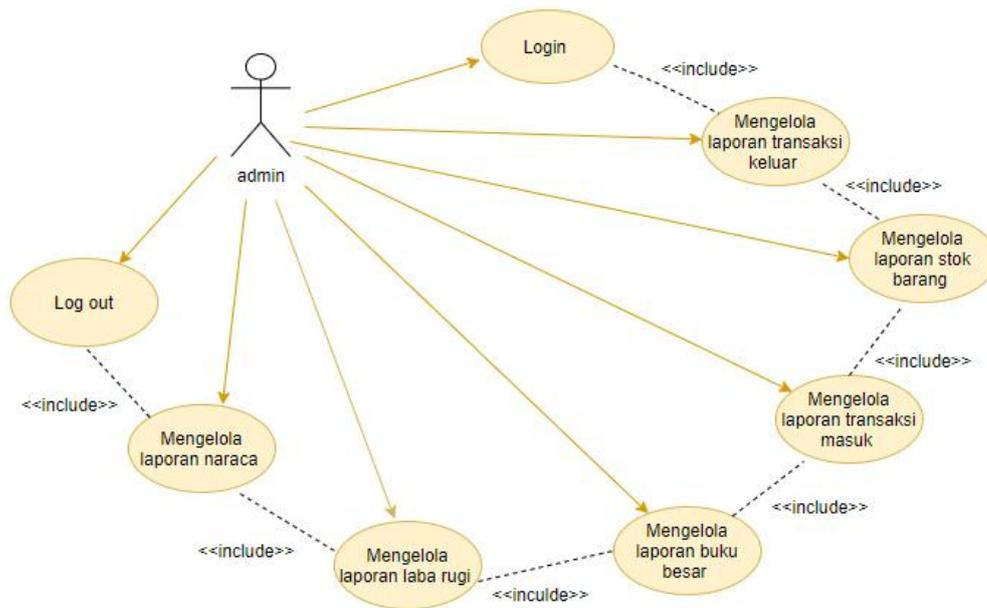
Gambar 2. Use case Diagram Sistem Informasi Keuangan
