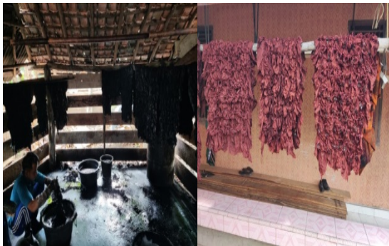
Gambar 5 Proses Pewarnaan dan pengeringan Batik Gambo Muba
