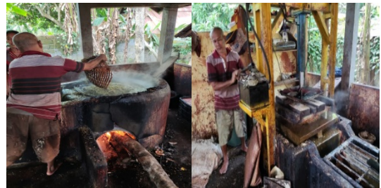
Gambar 2 Proses Perebusan Kedua dan Pemisahan Sari Gambir dari ampasnya
