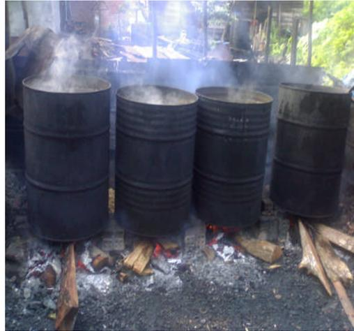
Gambar 2. Sistem Perebusan Kacang Kedelai saat ini
