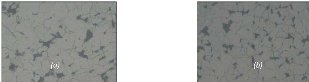
Gambar 9. Struktur Mikro Baja sebelum di Keraskan. Penampang melintang (a), penampang memanjang (b). Etsa 3% Nital, M200x
