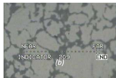
Gambar 5.16 Struktur Mikro Baja setelah pack carburizing Holding time 4jam dan dilakukan Double quenching . Bagian tepi (a), Bagian tengah (b). Etsa 3% Nital, M200x
