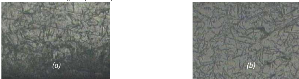
Gambar 11 Struktur Mikro Baja setelah pack carburizing Holding time 2jam dan dilakukan Single quenching. Bagian tepi (a), Bagian tengah (b). Etsa 3% Nital, M200x
