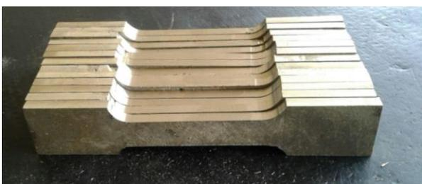
Gambar 8. Spesimen uji Tarik
