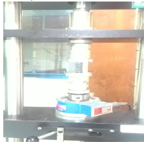
Gambar. 6 Proses Pengujian Compression untuk spring bagian depan
