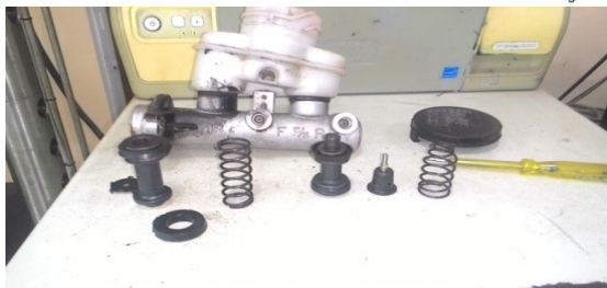
Gambar 5. Fungsi Spring pada Master siliner di bagian atas
