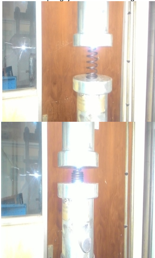
Gambar 7. Proses Pengujian Compression untuk spring bagian belakang
