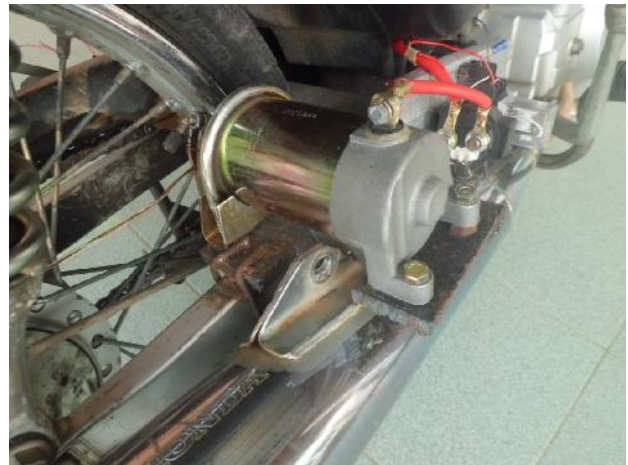
Foto 5 Instalasi ABS yang dikembangkan
