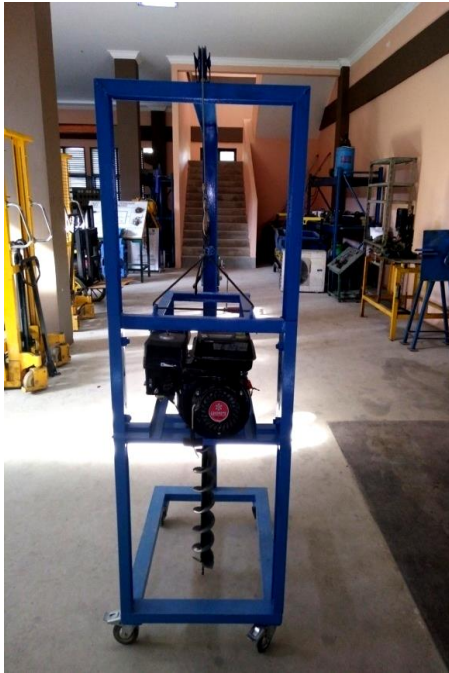
Gambar 7. Mesin bor biopori Hasil Rancangan
