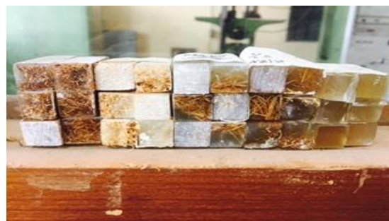
Gambar 4.1 Spesimen uji impact setelah diuji
