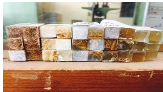
Gambar 4.1 Spesimen uji impact setelah diuji
