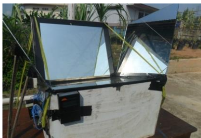
Gambar 2. Kompor Surya Tipe Kotak Dengan Tambahan Cermin Reflektor
