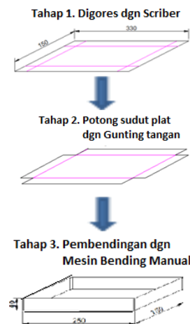
Gambar 2. Proses Pengerjaan Manual
