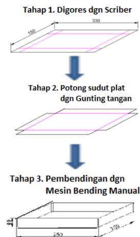
Gambar 2. Proses Pengerjaan Manual
