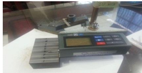
Gambar 6. Proses Pengujian Kekasaran Permukaan
