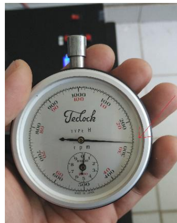
Gambar 5. Membaca hasil uji tachometer
