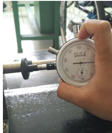
Gambar 4. Pengujian dengan tachometer
