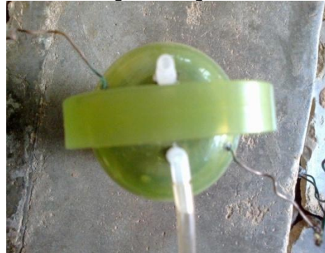
Gambar 2. Lubang kabel dan udara
