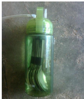
Gambar 4. Desain generator HHO
