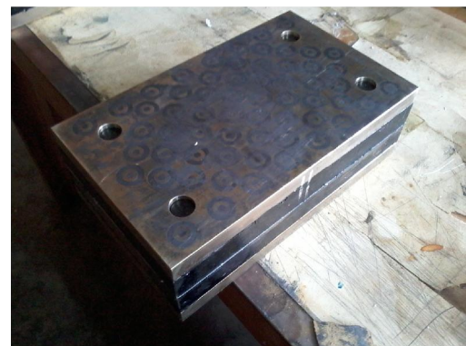
Gambar 8 : Menyatukan Spesimen untuk Mengetahui Kerataan Permukaan
