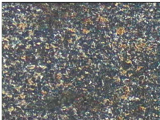
Gbr. 18. Struktur Mikro perlakuan : Pemanasan, 850 °C, Penempaan, Pendingian Pendingian
