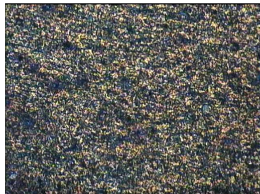
Gbr. 19. Struktur Mikro perlakuan : Pemanasan, 850 °C, Penempaan,
