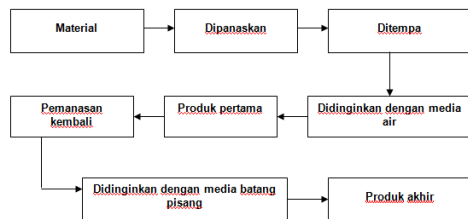
Gambar 2. Aliran Proses Pembuatan Produk Pandai Besi Setelah Perbaikan
