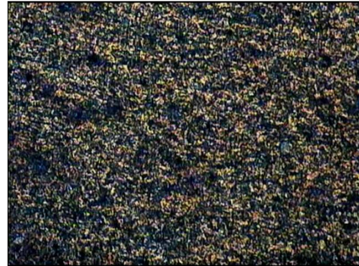
Gbr. 23. Struktur Mikro perlakuan : Pemanasan 850°C, Penempaan, Pendingin Air, Pemanasan 850°C, Pendingin Batang Pisang Waktu 15 Menit Arah Melintang 200 X, Etsa Nital 3%, Austenit, Martensit
