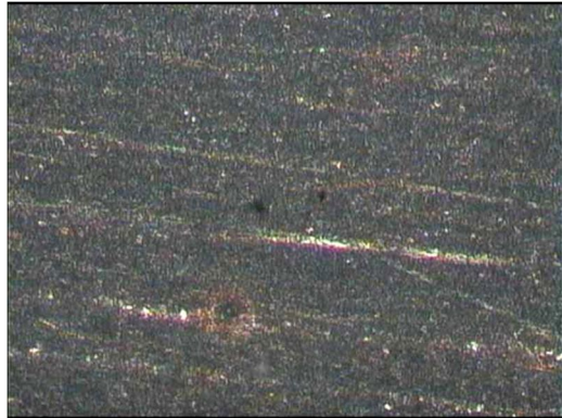
Gbr. 20. Struktur Mikro perlakuan : Pemanasan 850°C, Penempaan, Pendingin Air, Pemanasan 850°C, Pendingin Batang Pisang Waktu 10 Menit Arah Melintang 200 X, Etsa Nital 3%, Austenit, Martensit
