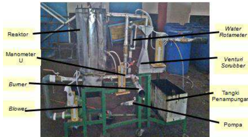
Gambar 2 : Alat Gasifikasi Sistem Updraft Double Gas Outlet
