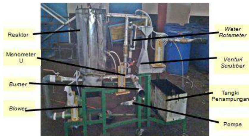
Gambar 2 : Alat Gasifikasi Sistem Updraft Double Gas Outlet
