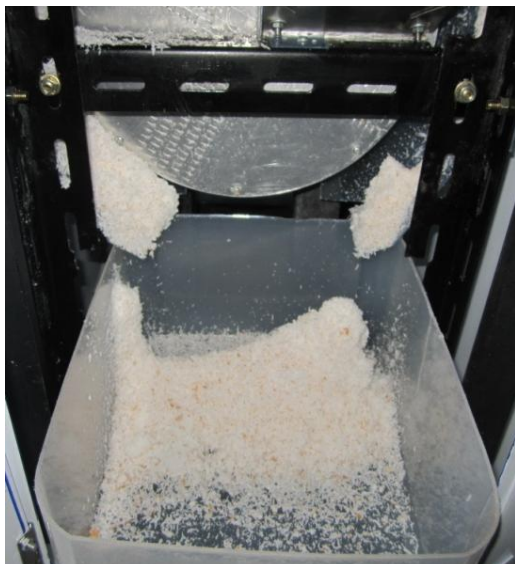
Gambar 11. Pengujian Mesin Saat Memarut Tanaman Umbi-Umbian (Singkong).
