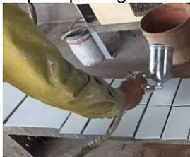
**Gambar 4.** Pengecatan Spesimen
