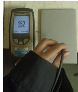
**Gambar 6.** Pengukuran Ketebalan
