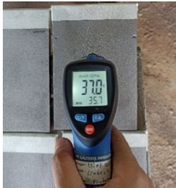
Gambar 3. Mengukur Temperatur Substrat
