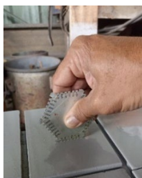
Gambar 5. Proses Pengukuran WFT
