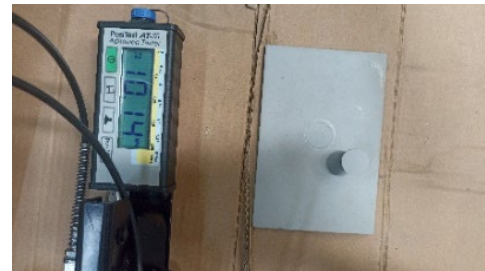
Gambar 7. Hasil Pengujian Daya Rekat Cat
