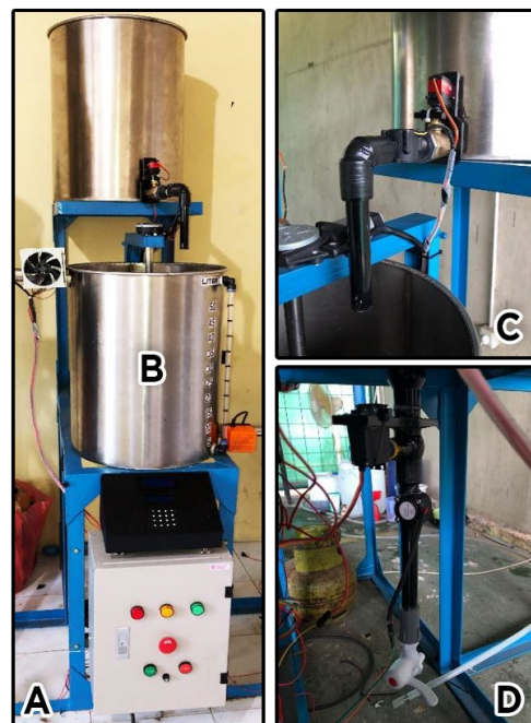
Gambar 4. (a) Konstruksi Mesin Pemurnian (b) Tangki Pemurnian dengan Sistem Pendingin (c) Katup Suplai Akuades (d) Katup Pembuangan Gliserin
