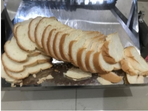
Gambar 8. Hasil pemotongan roti 1400 rpm \pm 10\%
