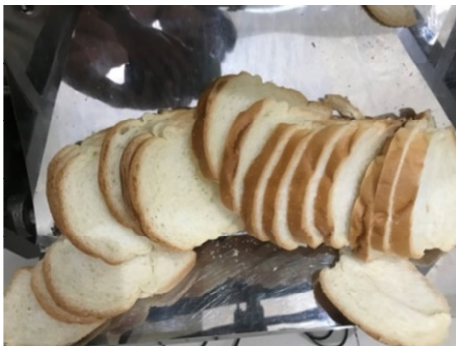
Gambar 6. Hasil pemotongan roti 600 rpm \pm 10\%
