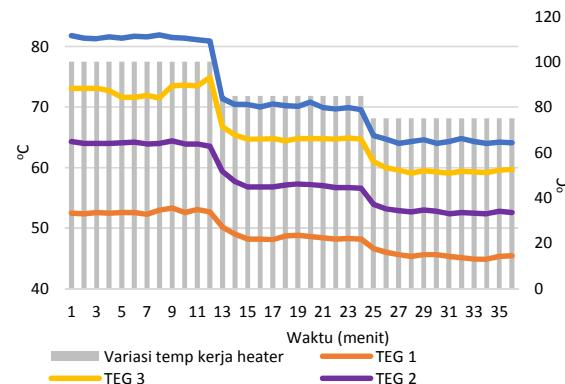
Gambar 4. Perbandingan temperatur sisi panas modul TEG 1 s.d 4
