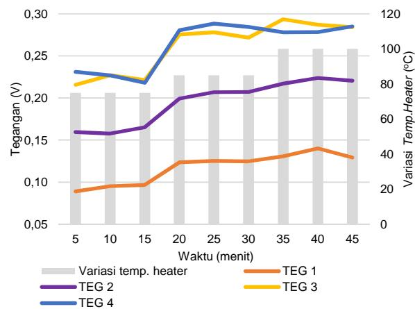
**Gambar 12.** Perbandingan tegangan individual modul TEG 1 s.d 4
