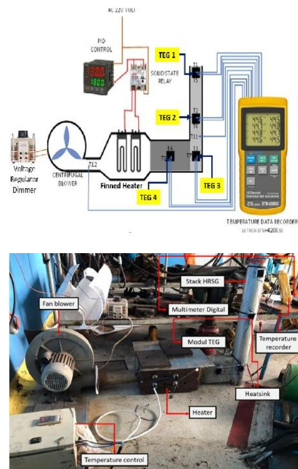
**Gambar 1.** Skematik Uji Panas Sisa Gas Buang HRSG ke energi listrik dengan modul TEG
