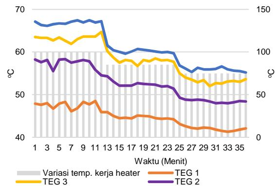
Gambar 5. Perbandingan temperatur sisi dingin modul TEG 1 s.d 4
