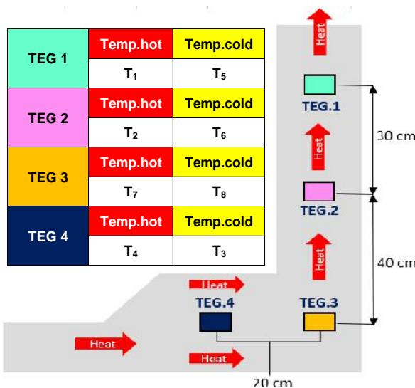
**Gambar 2.** Posisi Penempatan Lokasi Modul TEG dan Titik Termokopel
