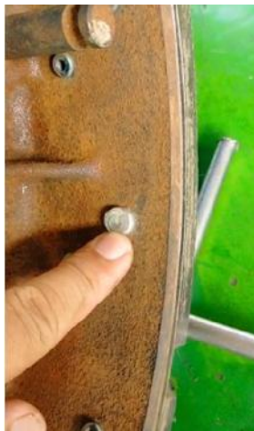
Gambar 6. Rivet Terpasang pada Bodi
