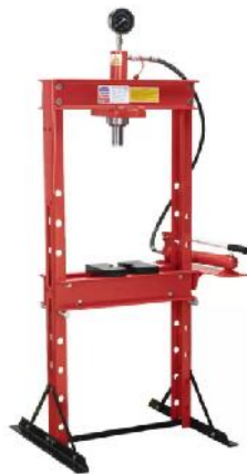
Gambar 7. Mesin Pres Penekan Rivet
