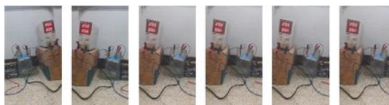
Gambar 5. Sintesis Graphene menggunakan Larutan Elektrolit CH_3COOH 1M
