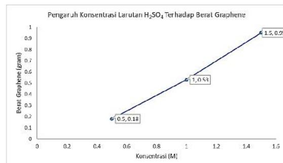
**Gambar 7.** Pengaruh konsentrasi Larutan  $H_2SO_4$  Terhadap Berat Graphene
