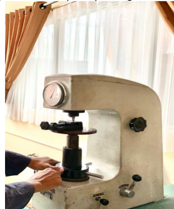
Gambar 5. Proses Pengujian Kekerasan
