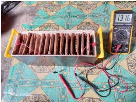
Gambar 8. Prototipe Pembangkit Listrik Tenaga Air Gambut dengan Eleketroda Logam Bekas Cu-Zn
