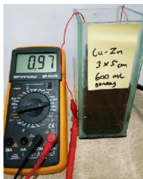
Gambar 4. Pengujian Variasi Volume Air Gambut dengan Elektroda Cu-Zn 3 x 5 cm 2
