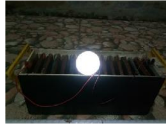
Gambar 9. Hasil Pengujian Prototipe Pembangkit Listrik Tenaga Air Gambut Elektroda Cu-Zn dalam Menyalakan Lampu LED 12 V
