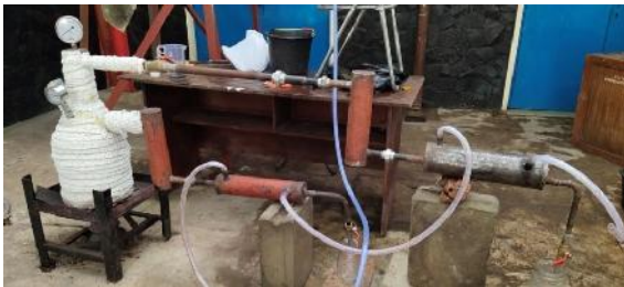
Gambar 2 Alat Pengolahan Limbah Oli Bekas Menjadi Bahan Cair Dengan Perlakuan Panas
