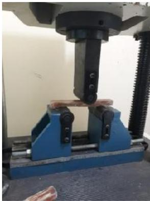
Gambar 11. Proses Pengujian Bending
