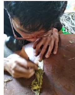
Gambar 2. Proses Pengambilan Serat Daun Nanas Menggunakan Scrub
