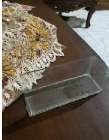
**Gambar 4.** Cetakan Spesimen
