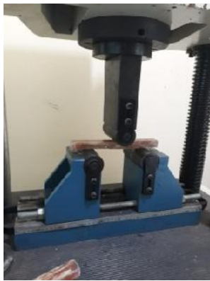
Gambar 11. Proses Pengujian Bending
