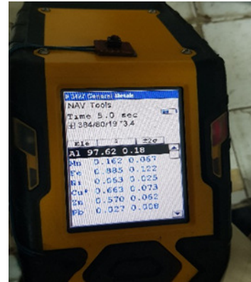
Gambar 7. Komposisi kimia material Aluminium
