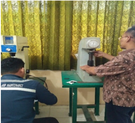
Gambar 5. Proses Pengujian Kekerasan
