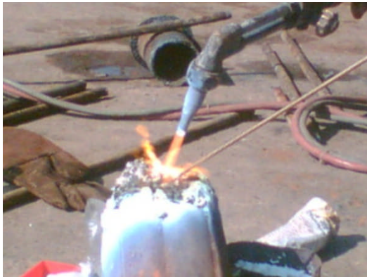
Gambar 4.9 Penambahan kuningan Pembentukan drill bit sesuai yang dibutuhkan.
