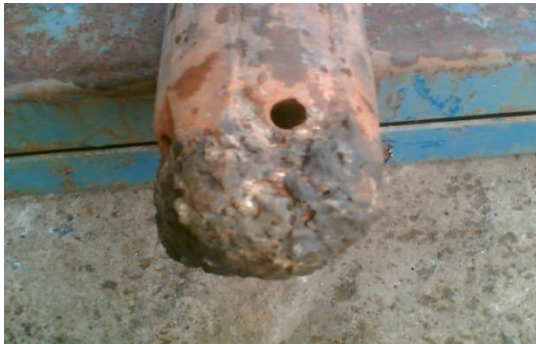
Gambar 4.1 Drill bit yang akan di perbaiki
