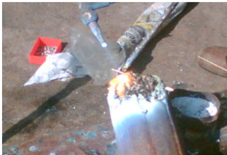
Gambar 4.7 Pemanasan drill bit dan kawat las
