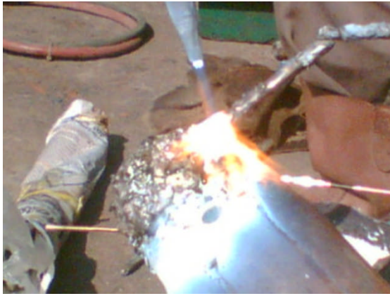
Gambar 4.8 Penyatuan tungsten bit dengan drill bit
