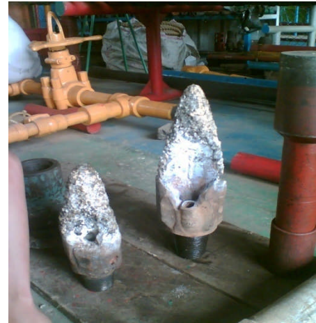
Gambar 4.10 Bentuk-bentuk drill bit yang sudah diperbaiki.
