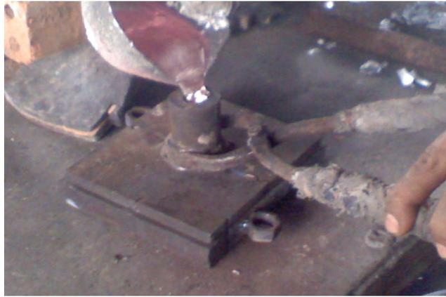
**Gambar 3.6** Proses penuangan cairan Aluminium
