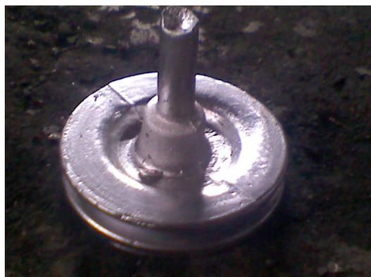
**Gambar 3.5** Hasil cetakan (*Pulley*)
