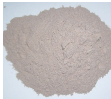
Gambar 3. Fly Ash setelah dikalsinasi
