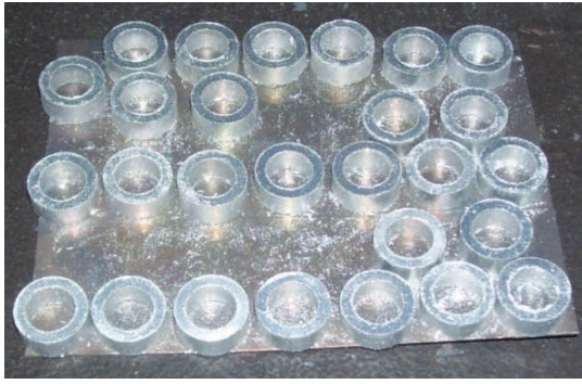
Gambar 6. Spesimen hasil proses sinter
