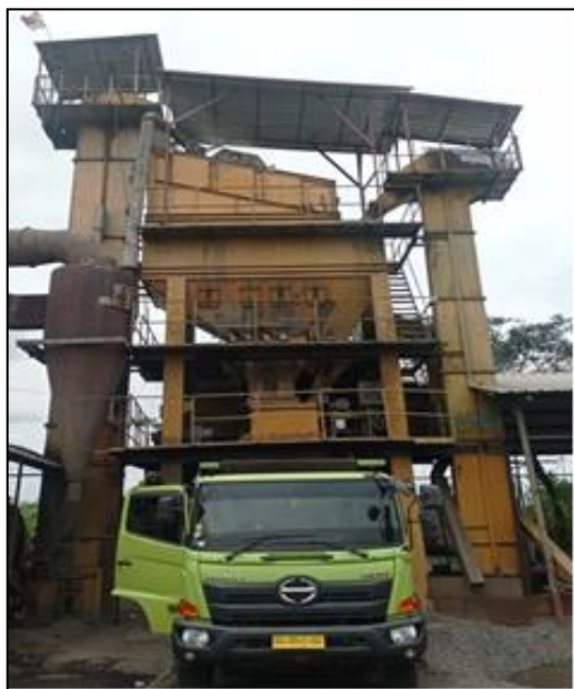
Gambar 12. Job Mix Formula dituang ke dalam Dump truck
