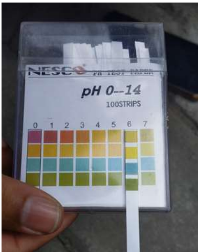
Gambar 8. Tim KKN melakukan uji pH sampel limbah cair tahu.
