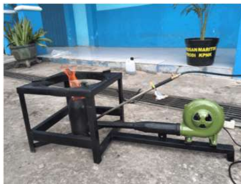
Gambar 2. Kompor oli bekas yang sudah selesai dibuat dan akan diserahkan kepada mitra PKM
