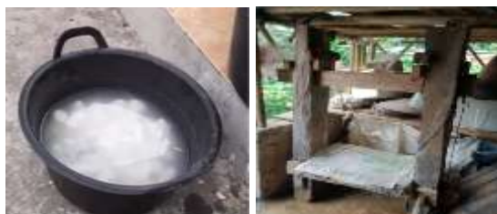
(a) (b) Gambar 3. (a) Proses Perendaman dan (b) Pembuangan Kandungan Zat yang Berbahaya Dengan Cara Dijepit/Press,
