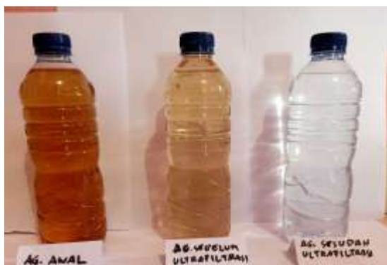
Gambar 6. Perbandingan gambar air gambut sebelum dan sesudah proses ultrafiltrasi
