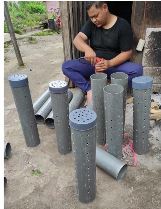
Gambar 4. Proses Pembuatan Lubang Pipa PVC
