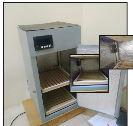
Gambar 3.5 Realisasi Alat Pengering Mase Keramik
