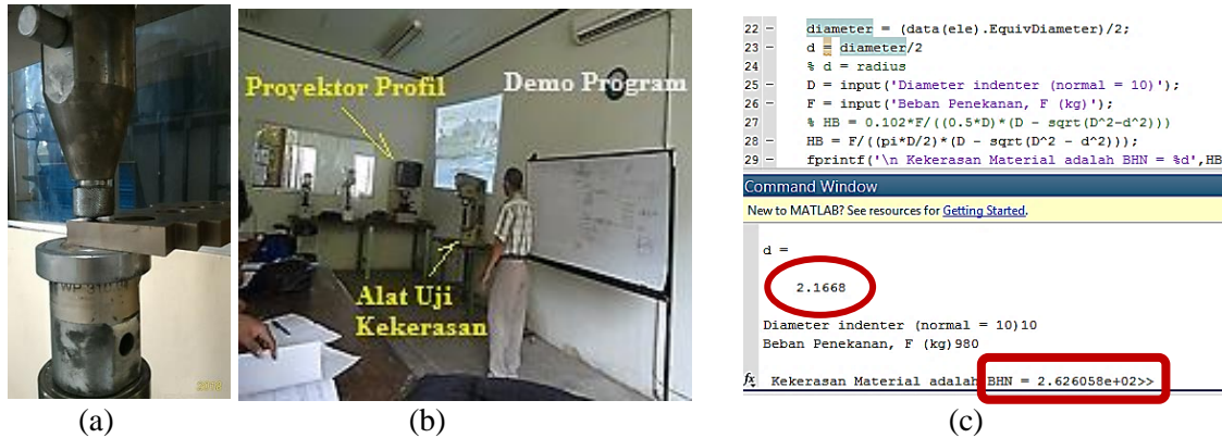
Gambar 2. (a) Proses Penekan Indentor (b) Pengukuran Indentasi dan (c) Skrip Program
