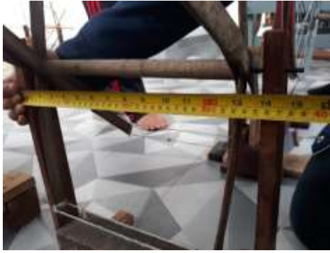
Gambar 4 Pengukuran Lebar Penggulung Benang yang akan dipindahkan ke Golongsongan.
