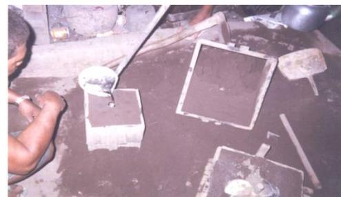
Gambar 6. Proses Penuangan di Cetakan
