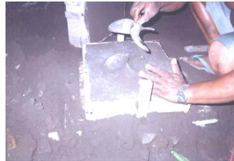
Gambar 5. Proses Pembuatan saluran pada Cetakan Pasir
